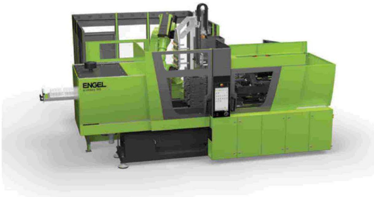
Stampo a 64 cavità, pressa a iniezione senza colonne e-victory, sistema di supervisione iQ process observer e automazione compatta, portano la mass production di valvole a ombrello in silicone liquido a un nuovo livello di efficienza. Foto ENGEL
