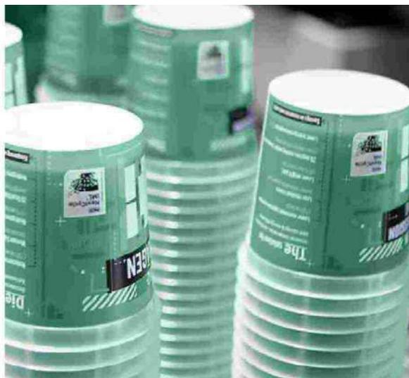
**I contenitori prodotti al Plast su una pressa elettrica Arburg Allrounder 720 A Ultimate, equipaggiata con uno stampo a 4 cavità e con un robot a entrata laterale di Brink Moulds & Automation**
