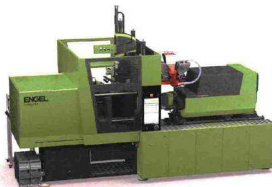
La digitalizzazione della pressa elettrica e-mac permette, secondo il costruttore Engel, di ridurre il consumo energetico fino al 67% rispetto alle tecnologie in commercio, garantendo precisione e ripetibilità.
