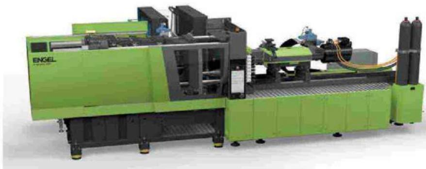
*Grazie al nuovo gruppo di iniezione potenziato, la pressa e-speed raggiunge una velocità massima di 1.400 mm/s e una pressione di iniezione fino a 2.600 bar in presenza di stampate di peso ridotto e un rapporto estremo tra spessore di parete e percorso del fuso (Foto Engel)*
